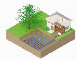
Pompe à chaleur sur capteurs enterrés horizontaux
