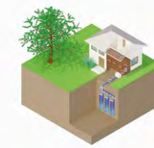
Pompe à chaleur sur corbeilles géothermiques
